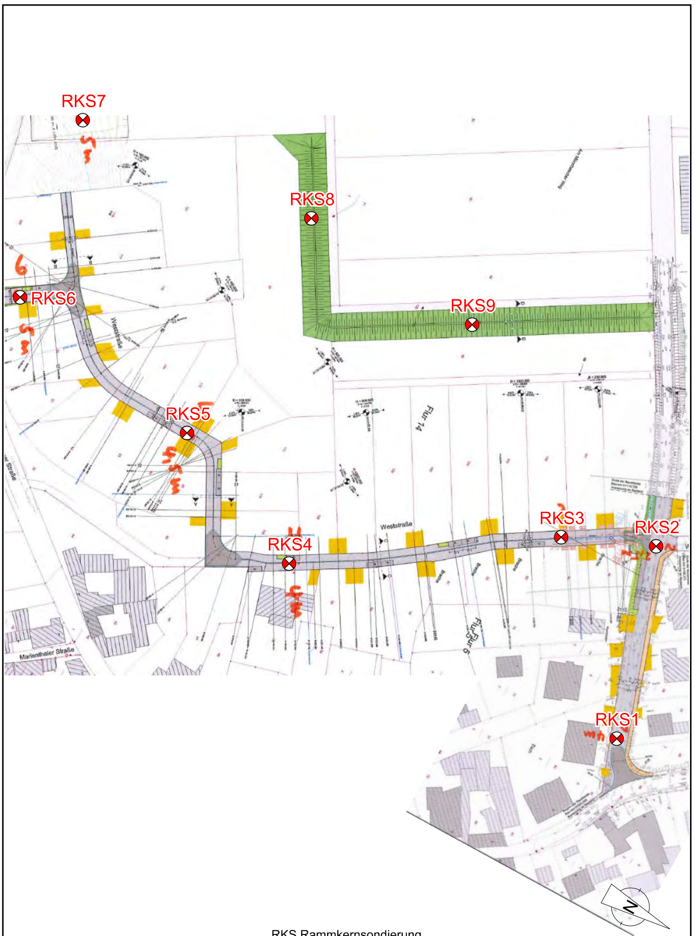
RKS Rammkernsondierung
